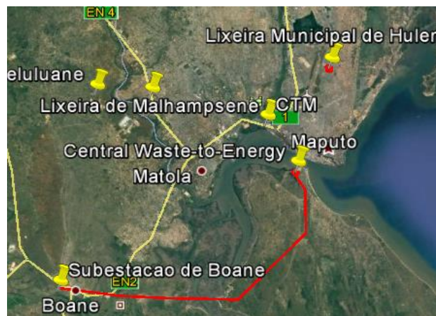
Figura 30: Trajecto das linhas de interligação da central a rede nacional de energia.
