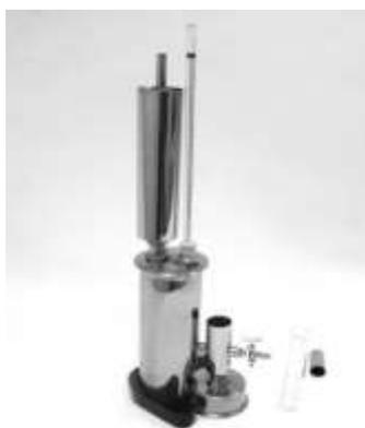
**Figura 3.2.** Ebuliómetro usando para determinar o teor alcoólico
