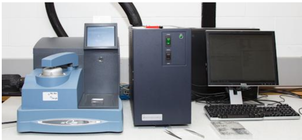
Figura 3. Equipamento usado para determinação do grau de gelatinização (Gelatinizador)
