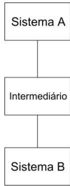
Figura 2-6: Topologia em estrela com dois sistemas
