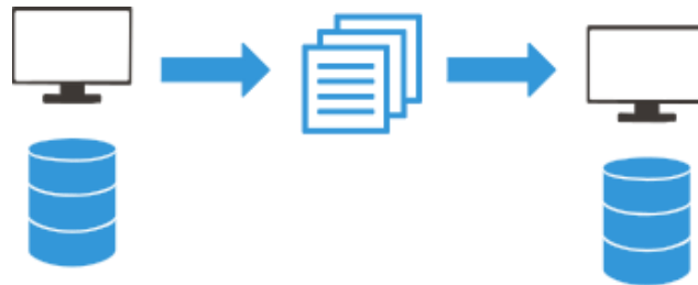
Figura 2-8: Integração por transferência de ficheiros.
