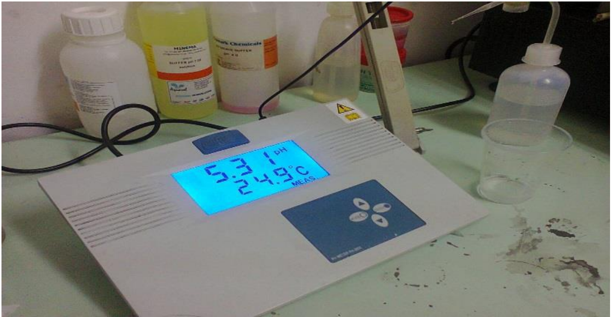
Figura 18. Potenciômetro usado na determinação do pH da polpa e do néctar de cajú.
