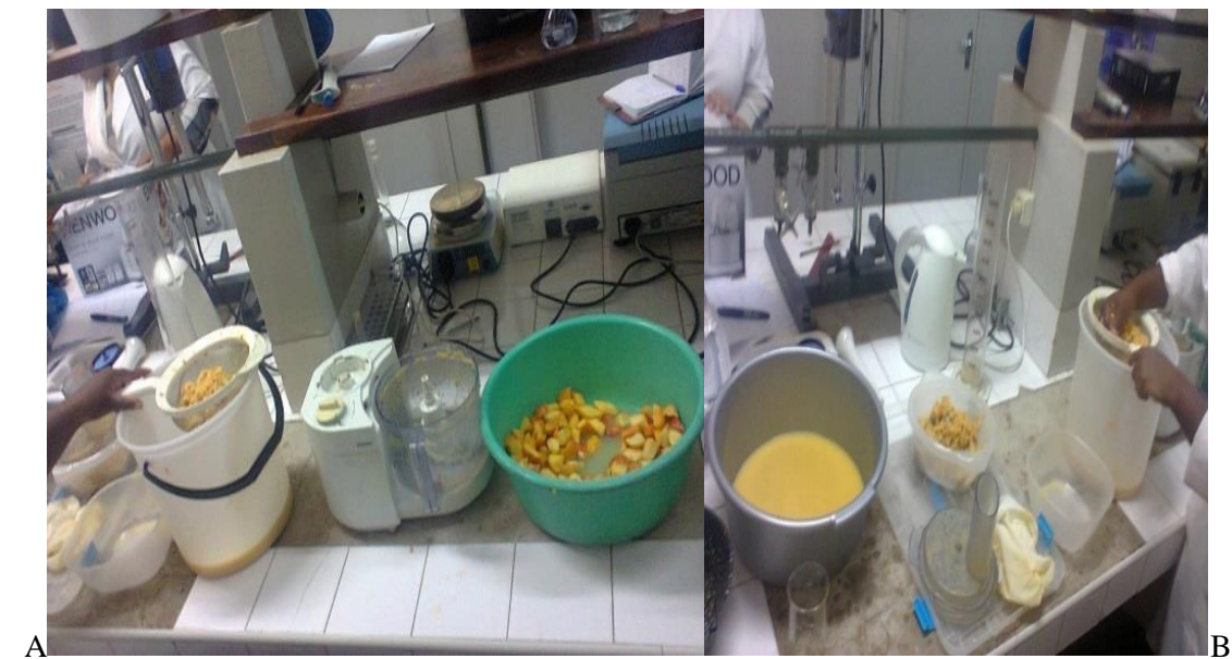
Figura 15. Despolpamento do pedúnculo e filtração da polpa de caju .
