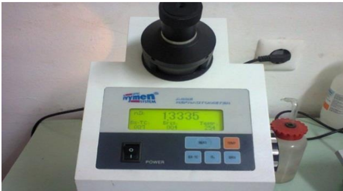
Figura 19. Refratômetro usado na leitura do Brix.
